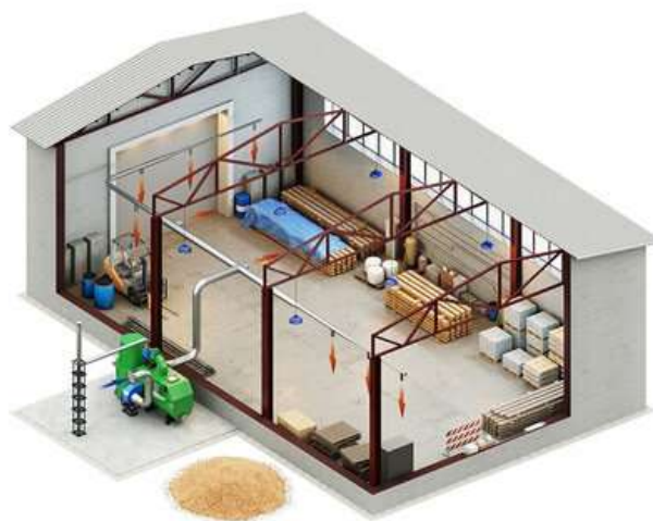
Рис. 5. Комбинированная система отопления
