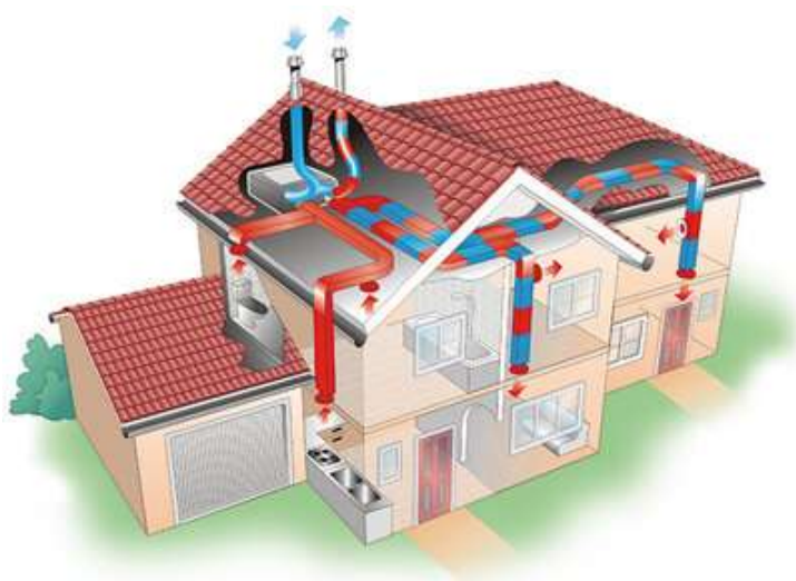
Рис. 3. Рециркуляционное воздушное отопление
